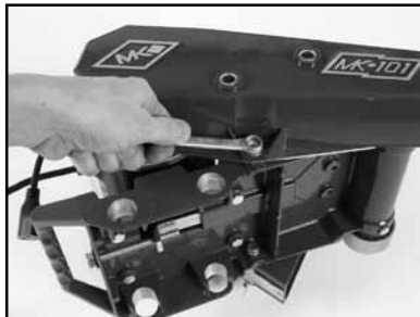
(D) Remove belt guard bottom bolt.
