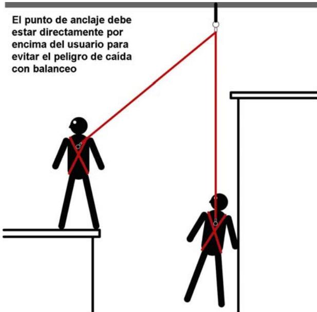
Asegúrese de tomar en cuenta la caída con balanceo al calcular sus requisitos de caída despejada y verificar el trayecto de caída para peligros e instrucciones. No hacerlo puede ocasionar lesiones graves o la muerte. Si usted tiene alguna pregunta sobre la caída libre, la caída despejada, la caída con balanceo u otros peligros en el trayecto de caída, asegúrese de ponerse en contacto con *FallTech* o consultar a una persona competente o a su supervisor directo en su sitio de trabajo.
