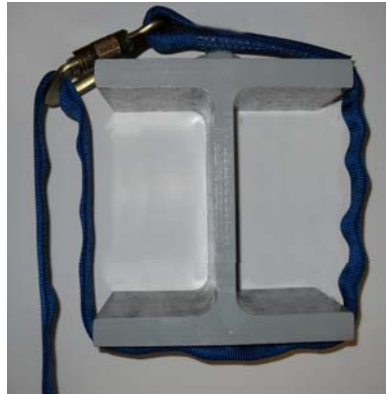
Conexión incorrecta del amarre
