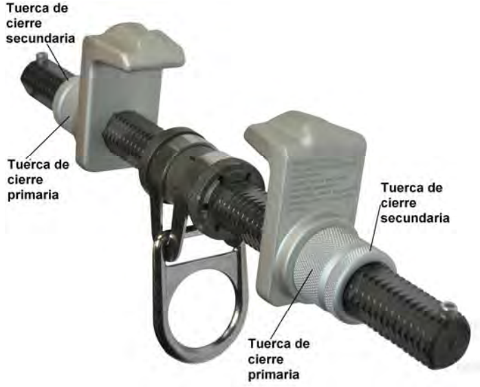
Fig. 3.4 Anclaje de viga con posición fija (7533 y 7534)
