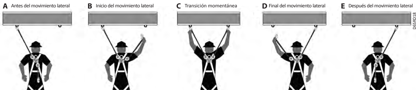
Fig.8: Uso del SRD doble para el movimiento lateral A Ubicación de trabajo original antes del movimiento lateral B A partir del movimiento lateral; una pierna conectada al anclaje C Durante el movimiento lateral; ambas piernas conectadas en transición momentánea entre los anclajes D Final del movimiento lateral; una pierna conectada al anclaje E Nueva ubicación de trabajo después del movimiento lateral
