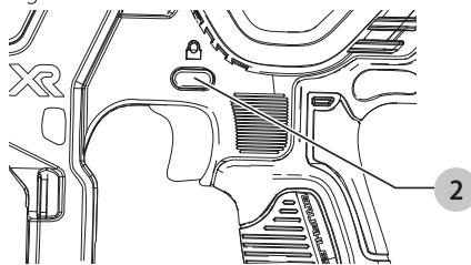
Lorsque le verrouillage de gâchette sera poussé sur la gauche, l'outil sera pleinement opérationnel. Le verrouillage de gâchette devrait systématiquement être verrouillé chaque fois qu'un réglage est effectué ou que l'outil est hors utilisation immédiate.
