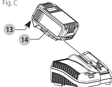
2. Insérer le bloc-piles **14** dans le chargeur, en vous assurant qu'il y est correctement calé. Le voyant rouge (charge) clignotera de façon continue indiquant que le cycle de chargement a commencé.
