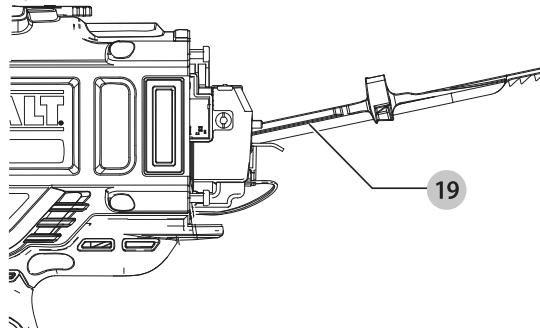
10. Remettez le mandrin, les tiges du guide, les butoirs et le capuchon de l'extrémité du boîtier sur l'outil. Il est important de vérifier l'alignement de l'enfonceur et du volant moteur avant de revisser le capot du boîtier sur l'outil. Cela peut être effectué en connectant un bloc-piles et en poussant puis relâchant le nez de l'appareil contre un établi ou une surface dure. Cela devrait faire tourner le moteur.
