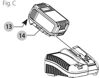
2. Inserte la batería 14 en el cargador, comprobando esté bien fija. La luz roja (de carga) parpadeará continuamente para indicar que se ha iniciado el proceso de carga.
