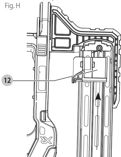
3. Déposez les bandes d'agrafes dans la fente de chargement du magasin en vous assurant que les têtes des agrafes s'alignent bien avec l'ouverture de la fente. (Consultez **Caractéristiques des agrafes** pour déterminer la taille compatible.)
