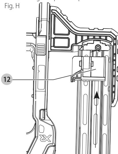
3. Coloque las tiras de grapas en la ranura de carga del cargador, asegurándose que las cabezas de las grapas estén alineadas correctamente con la abertura de la ranura. (Consulte **Especificaciones de grapas** para determinar el tamaño compatible).
