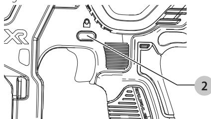
Cuando se presiona el botón de bloqueo del gatillo hacia la izquierda, la herramienta funciona adecuadamente. El botón de bloqueo del gatillo debe estar bloqueado siempre que se realicen ajustes o cuando la herramienta no vaya a utilizarse de inmediato.
